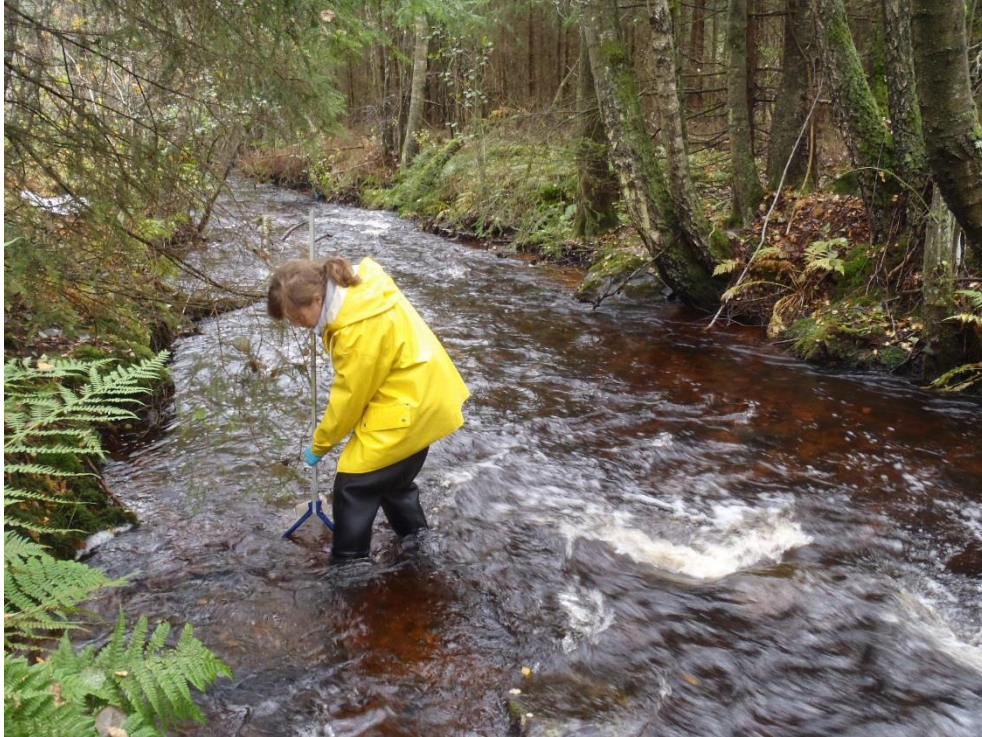
Figur 1. Provtagning med sparkmetoden i ett vattendrag. I ett stillastående vatten som en sjöitoral förs håven sakta genom vattnet och mycket nära den fot som rör upp bottenmaterialet.
