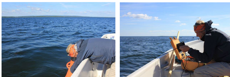
Bild 1. Under inventeringen från båt användes dels vanlig vattenkikare (vänster) samt en släpvideokamera (höger). Foto Kristianstad vattenrike.
