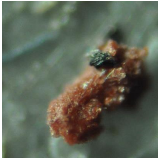
Figur 6. Röd partikel (potentiell båtbottnfärgspartikel) på 10 µm-filter.
