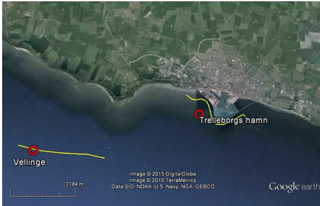
Figur 33. Provtagningsstationer i Vellinge och i Trelleborg. Röd cirkel markerar provtagning med vattenhämtare (10 µm-filter) och gul linje anger mantatrålning (300 µm-filter).
