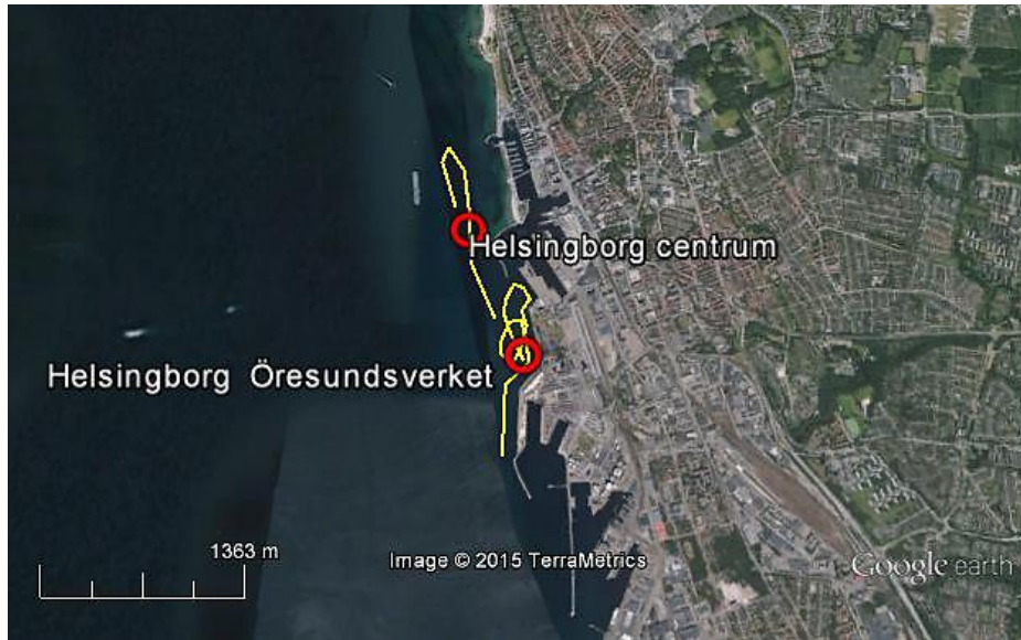
Figur 17. Provtagningsstationer i Helsingborg. Röd cirkel markerar provtagning med vattenhämtare (10 µm-filter) och gul linje anger mantatrålning (300 µm-filter).
