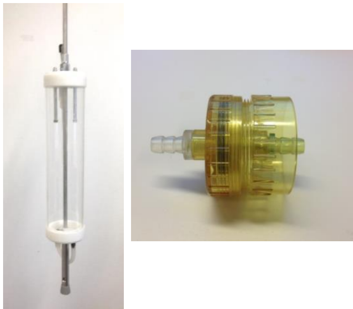
Figur 4. Bilden till vänster visar vattenhämtaren (kallad Ruttnerhämtare) och till höger visas hållaren för filter med maskvidden 10 \mu\text{m} .
