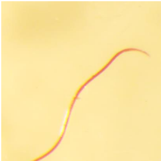
Figur 9. Plastfiber på 300 µm-filter
