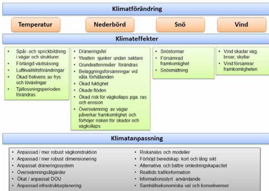
Figur 31: Översikt över klimatförändringarna som påverkar vägtransportsystemen, de specifika klimatkategorierna som förväntas påverka samt exempel på klimatanpassningsåtgärder (Arvidsson m.fl. 2012)
